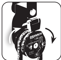
Enroulement de la corde Formez une boucle d'un tour et demi
