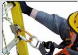
**HAKEN IN ARBEITSPOSITION, AUFFANGGURT und LANYARD.** Dies gewährleistet ausreichend Halt direkt zur Leiter.
